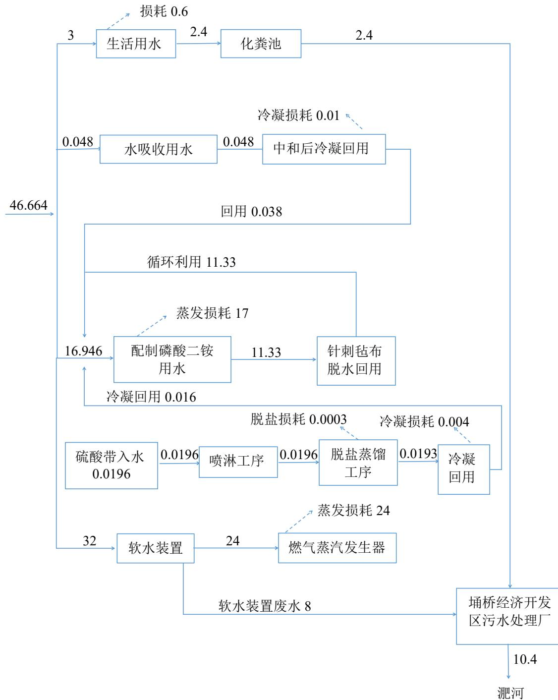
图 3.7-1 全厂水平衡图 单位: t/d
