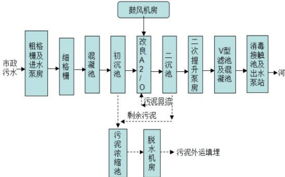
图 6.2-2 埋桥经济开发区污水处理厂污水处理工艺流程
