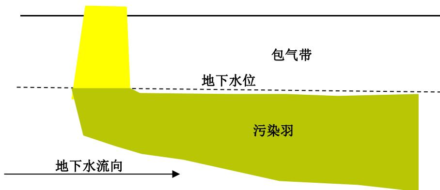
图 5.2-4 污染物迁移剖面示意图
